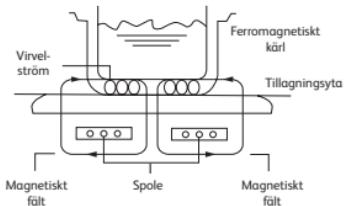
För att induktionsmetoden ska fungera korrekt måste tillagningskärlet vara ferromagnetiskt. (Mer information finns i sektionen Tillagningsredskap).
